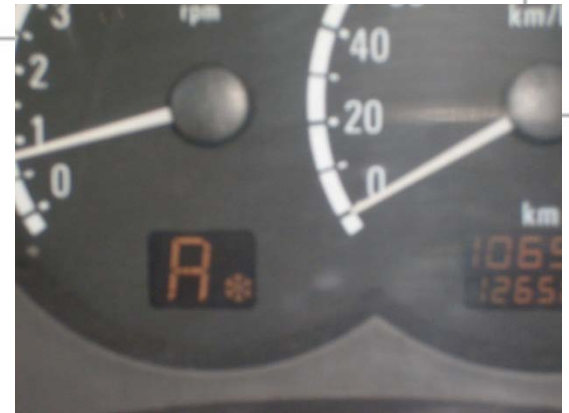
Palanca selectora en modo sport “el auto arrancara en segunda velocidad por eso es recomendable poner este modo una vez que el vehículo arranque a más de 20 km / hr.
