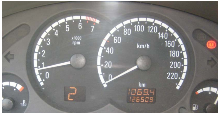
Palanca Selectora en modo manual engranado en segunda velocidad
