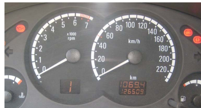
Palanca Selectora en modo manual engranado en primera velocidad
